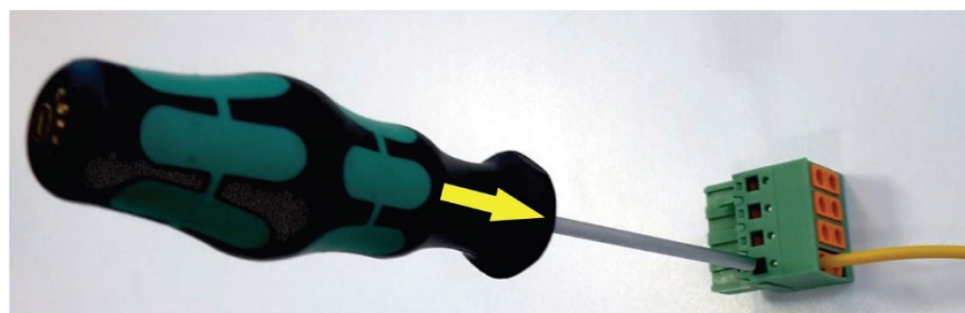
Fig. 16 Preparando los conectores X4 y X5
